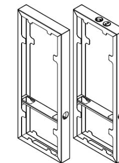
Modul zur Aufstellung Rücken an Rücken inklusive Durchlass Ø 6 cm benutzerseits zur Durchführung von Kabeln. Befestigungsmöglichkeit für Steckerleiste ist vorhanden. Zur Elektrifizierung können 2 Powerdot minis (Paket 1x 2 USB Lader und 1x Schuko-D) eingebaut werden.
