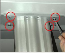
Tischplatte auf die Plattenauflagen legen und mit je vier Schrauben (Pos. 24\*) an den Säulen befestigen.
