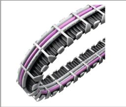
Optional kann die Kabelkette für dickere Kabelstränge vorder- und rückseitig genutzt werden, wenn jedes zweite Krallenpaar herausgenommen und zur Rückseite hin wieder eingesetzt wird.
