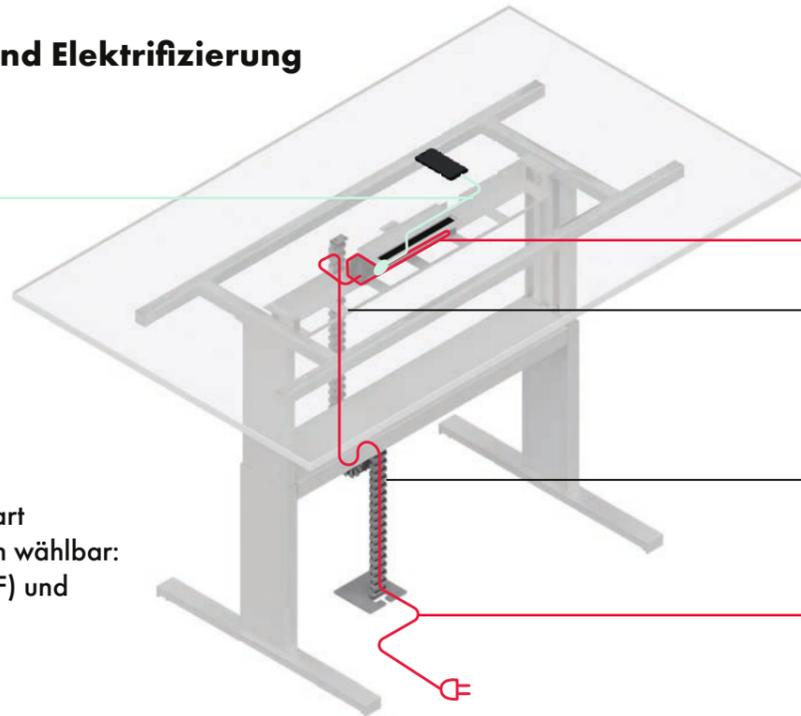
Steckerleisten in Kabelwanne unter der Tischplatte
