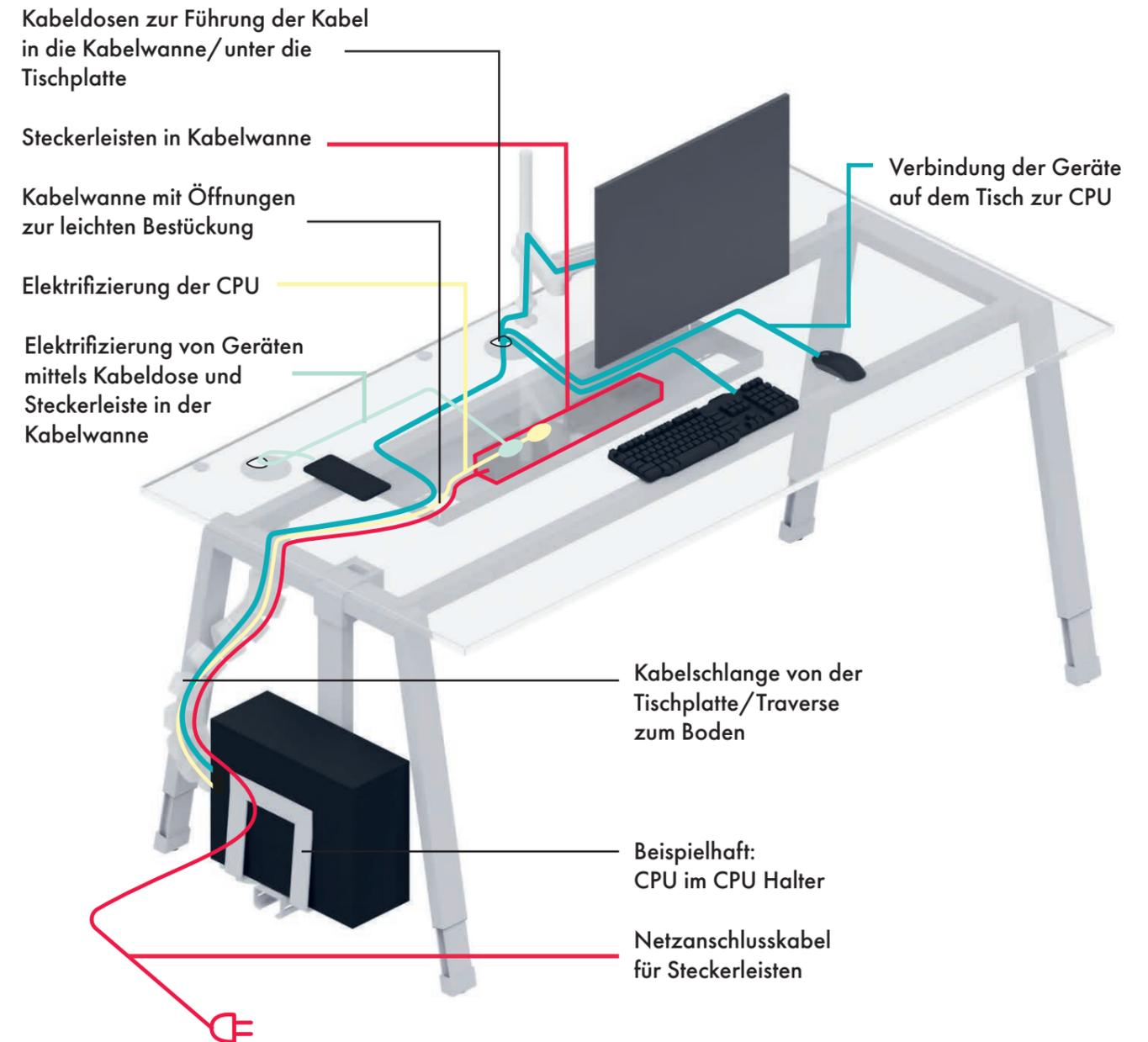
TUNE bietet ein rundum intelligentes Verkabelungssystem. Das Netzanschlusskabel kann von unten mittels Kabelschlange nach oben in die Kabelwanne geleitet werden. In der Kabelwanne wird die Steckerleiste fixiert und bietet genügend Platz für die Tischelektrifizierung. Die Kabeldurchlässe in der Tischplatte ermöglichen ein ordentliches Erscheinungsbild auf dem Tisch.
