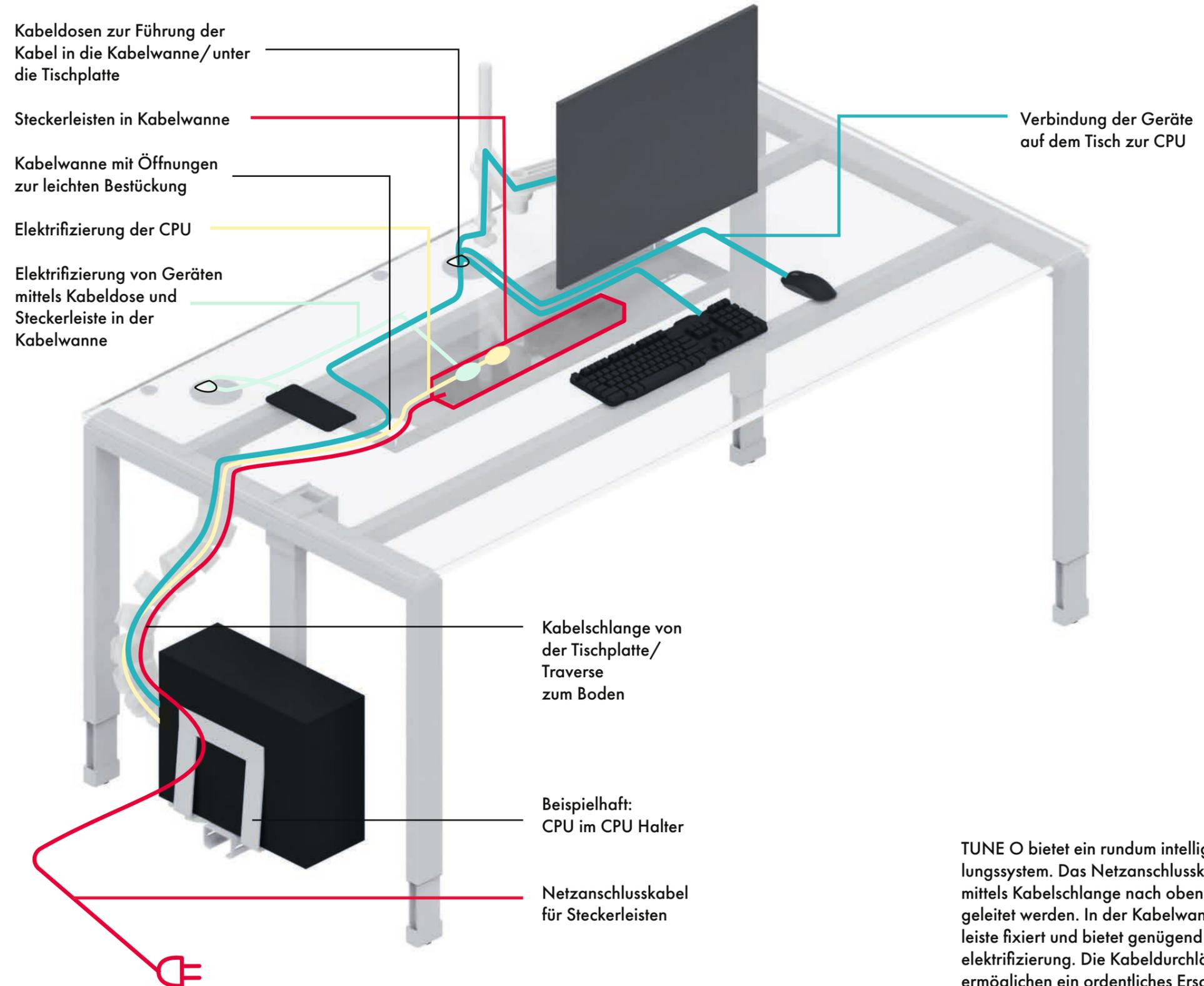
TUNE O bietet ein rundum intelligentes Verkabelungssystem. Das Netzanschlusskabel kann von unten mittels Kabelschlange nach oben in die Kabelwanne geleitet werden. In der Kabelwanne wird die Steckerleiste fixiert und bietet genügend Platz für die Tischelektrifizierung. Die Kabeldurchlässe in der Tischplatte ermöglichen ein ordentliches Erscheinungsbild auf dem Tisch.
