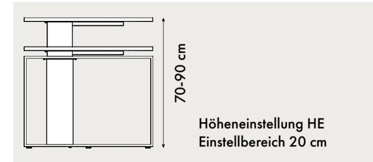
In festgestelltem Zustand, beträgt die statische Belastung bei allen Verstellarten des iMOVE F bis zu 120 kg. Die dynamische Belastung, die der Tisch während des Verstellens im Standard trägt, kann durch Zusatzgewichte erhöht werden. Der angegebene Lastbereich ist zwingend einzuhalten, da sonst die einwandfreie Verstellfunktion nicht gewährleistet ist.
